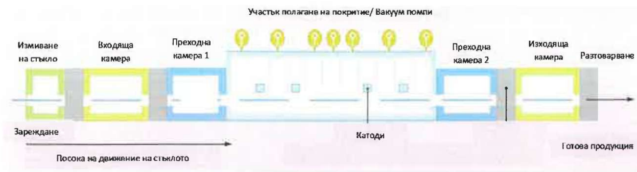
Фигура 2. Схема на процеса на производство на стъкло с покритие (устойчиво стъкло)
